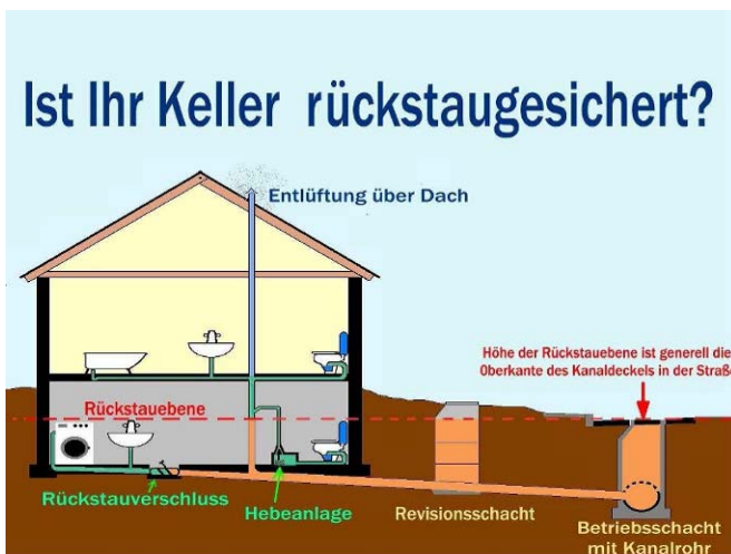
Abb.: die „Rückstauenebene“ ist im Regelfall die Straßenoberkante. Die Entlüftung der Abwasserrohre auf dem Dach wird oft mit einem kleinen Schornstein verwechselt.
