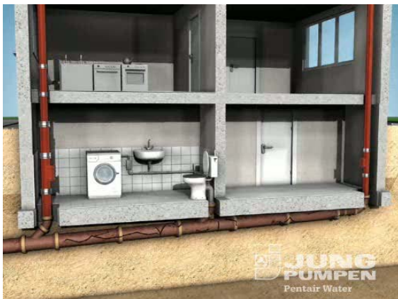
Abb.: Erneuerung einer schwer zugänglichen Leitung durch stilllegen des Altröhres und abhängen der neuen Leitung unterhalb der Decke (Quelle: Jung Pumpen)
