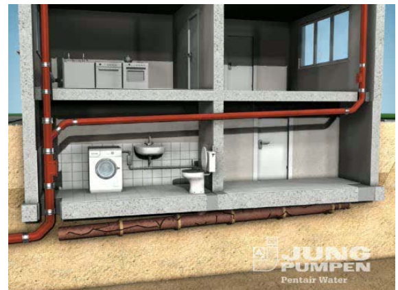
Abb.: Erneuerung einer schwer zugänglichen Leitung durch stilllegen des Altröhres und abhängen der neuen Leitung unterhalb der Decke (Quelle: Jung Pumpen)
